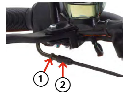
1. Contre-écrou 2. Ecrou de réglage
